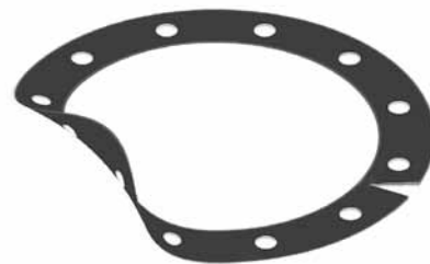
经仔细检查后，有时会发现人孔盖垫圈已脆裂或断开。
