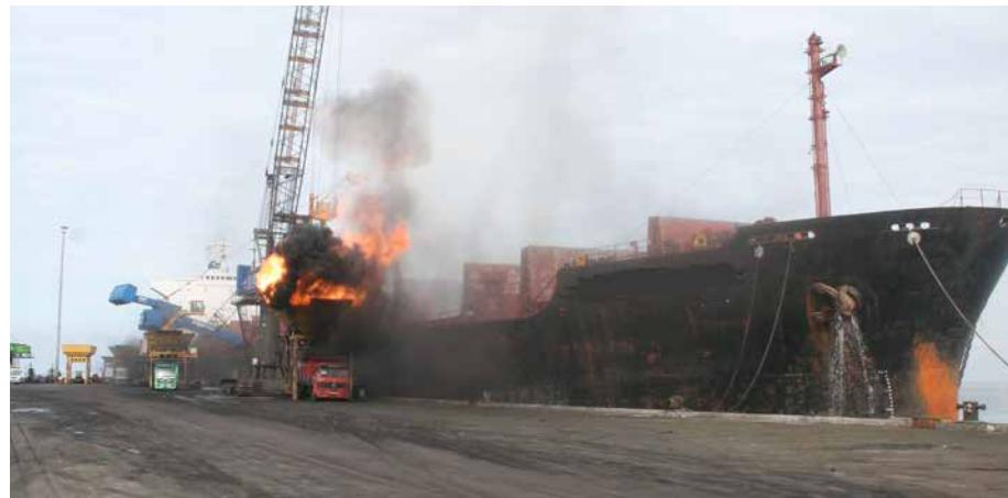
在装货期间以及装货工作完成之后，对已密封货舱进行可燃气体监控，可以进一步了解货舱内的货物状况。通常情况下，煤炭会释放出燃气和“蒸汽”，进而导致载货货舱含氧量下降，一氧化碳含量上升。当监测数据显示货舱内一氧化碳含量迅速上升、氧气含量急剧下降时，都可能表明载运货物发生了自热反应；但也不应排除货物正析出可燃气体或发生轻微氧化反应的可能性。因此，应对早期的检验数据进行审慎的分析；如果载运货物确实发生自热或者自燃现象，则应选择立即卸货或者封闭货舱、立即开航。但要在装货港卸货往往极其困难；如果船舶选择开航，就应确保在航行期间以及卸货过程中采用额外的安全措施，以确保上述危险得到有效的控制。另一种可供选择的解决方案是将“低温”的煤炭覆盖于已知或被怀疑是“高温”的煤炭上。但这显然不是首推的解决方案：因为这种方法有可能会加剧货物表面的自热反应，从而显著增加问题货物发生火灾的危险。如果自热现象发生在航行或卸货过程中，船长应及时向有关方面征询控制上述局面的相关建议。总之，确保上述货物安全运输的首要关键在于：确保货物在装运上船时没有自热迹象。
