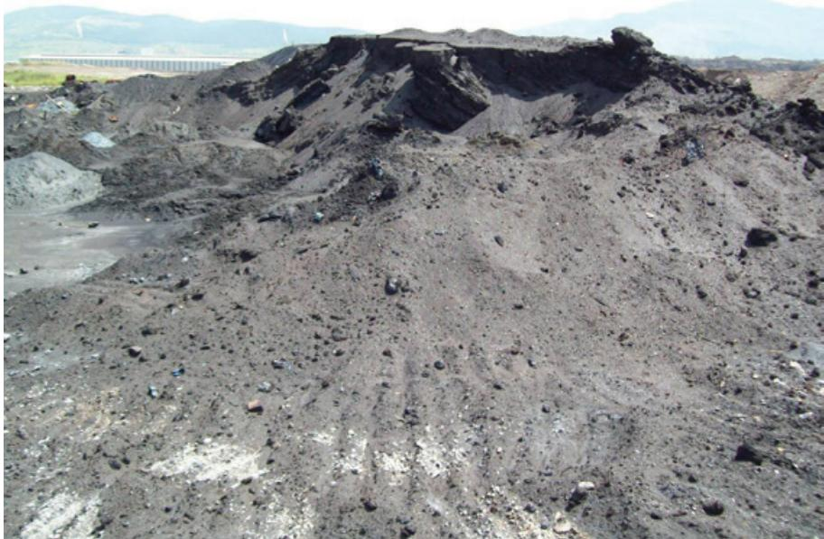
轧屑吸水性很强，水湿的轧屑货堆往往会在底部形成一层“湿底”。然而，为了满足一个航次对装货量的要求，往往需要从不同的货堆收集轧屑，其具体的颗粒大小就会因为不同的处理工艺而有所差异。因此，不同货堆的货物规格可能存在差异，而且
