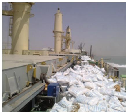
质量报告》通常会记录货物装运前的湿度，进而规定承运人据此援用货物固有缺陷进行辩护的可能范围。然而，货物积载不当和通风状况不佳会使承运人面临提单项下索赔的风险增加。为了最大程度地从租家处获得船东据提单赔付所产生损失的分摊，当事船员应尽职履行航次指令中列明的货物积载和通风要求，并做好相应的记录。货物衬垫应保持清洁、干燥，并使货物与货舱结构有效隔离，从而有效保护船载货物。如果所用衬垫明显不适格，船员应通知船东以便其考虑是否应向租家提出抗议。
