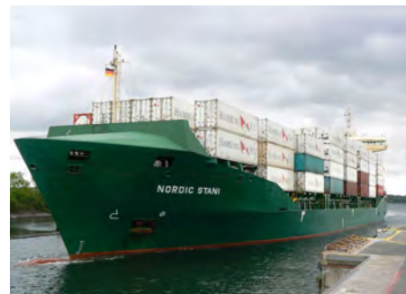
Sea Consortium Pte. Ltd. 旗下的“Nordic Stani”轮由伦敦保赔协会承保。该轮系拥有1,036标准箱的全格舱式集装箱货船 (fully cellular container)。
